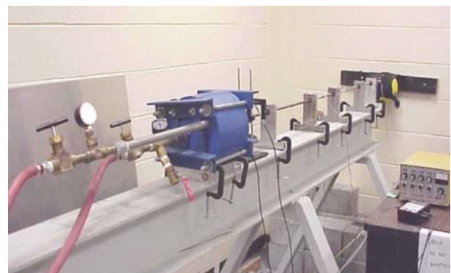
Fig. 2 Split-Hopkinson bar apparatus
